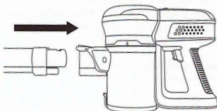
Для того чтобы отсоединить трубку, нажмите на клавишу фиксации трубки и потяните.
