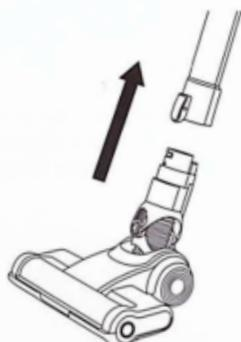
5. При необходимости вы можете использовать насадки без трубки, для этого подсоедините насадку непосредственно к корпусу пылесоса.
