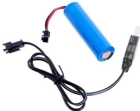
Для этого подключите к аккумулятору кабель с разъемом USB. Обратите внимание: чтобы отсоединить кабель от аккумулятора, необходимо нажать пальцем на зажим, расположенный на разъеме кабеля. Вставьте разъем в любой порт USB с силой тока не менее 1 А. Полная зарядка занимает ~2,5 часа. Пока идет зарядка, на разъеме USB горит красный светодиодный индикатор.
