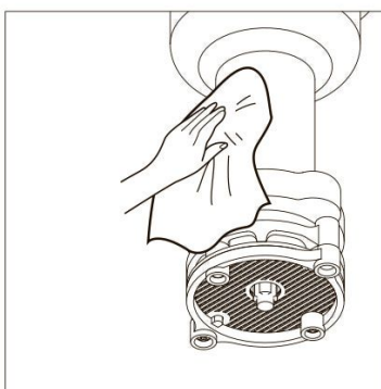
При чистке изнутри не переворачивайте устройство, электрод должен находиться по направлению к полу, чистите сухим полотенцем
