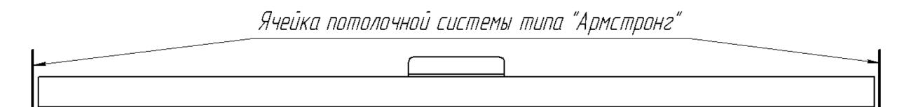
Рис. 3. Установка электрообогревателя в подвесной потолок типа «Армстронг».
